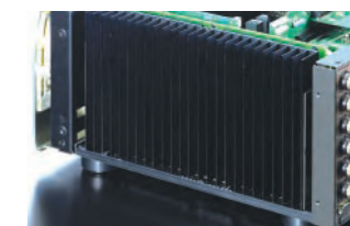
裝置在腳座正上方的散熱機構
